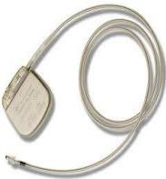
قطعة معدنية صغيرة الحجم تحتوي على بطارية التشغيل بالإضافة إلى العديد من الدوائر الكهربائية المعقّدة التي تعمل على إرسال ذبذبات كهربائية لتحفيز القلب.
